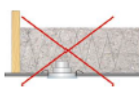
Spot non protégé au contact de l'isolant interdit
